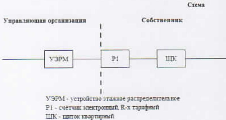
Исполнитель несет ответственность за надлежащее состояние и работоспособность питающих электрических сетей на квартиру согласно нижеуказанной схеме до прибора учета (пунктирной линией слева).
